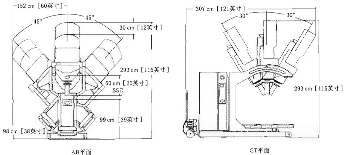
图 B.1 专用加速器旋转治疗范围示意图
