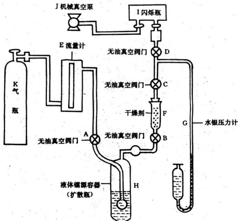
图 2 玻璃刻度系统示意图
